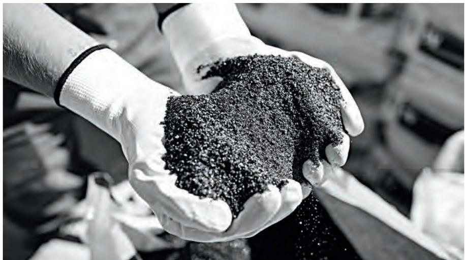
**SCHARFKANTIG** Schmelzkammerschlacke ist kein Spielsand, sondern ein Strahlmittel
