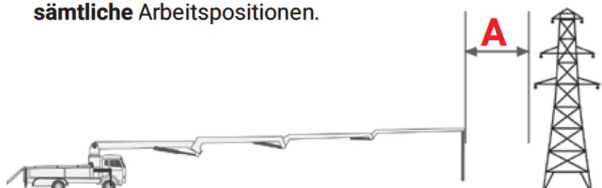
**Sicherheitsabstand zu spannungsführenden Leitungen**
