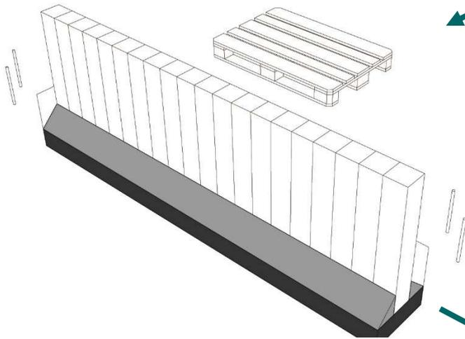
Après avoir posé les palissades, remplir les palissades de béton des deux côtés. Toutefois, restez au-dessous du niveau du sol
