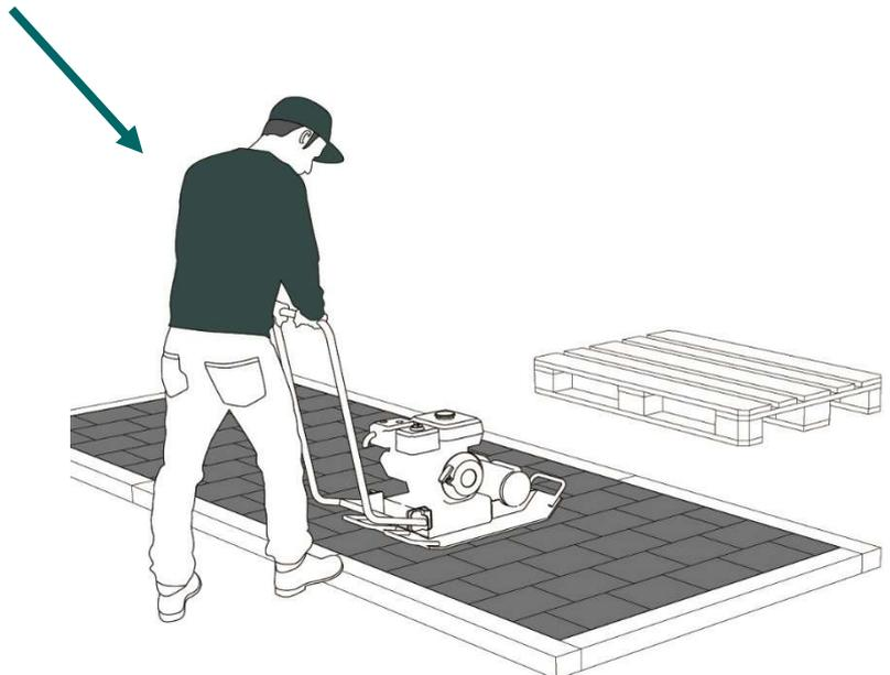
Pour ménager la surface du pavage, seules les plaques vibrantes de surface équipées de caoutchouc ou de tablier en plastique, doivent être utilisées. Le compactage des pavés est conseillé sur une surface sèche. Après avoir compacté, remplissez à nouveau les joints et balayez l'excédent et compacté à nouveau la surface.
